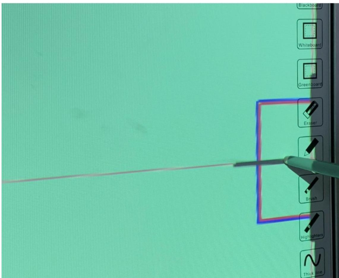
Dentro de "WhiteBoard" deberemos presionar en las esquinas de la pizarra utilizando el puntero táctil para llevar a cabo la calibración de la pantalla.
