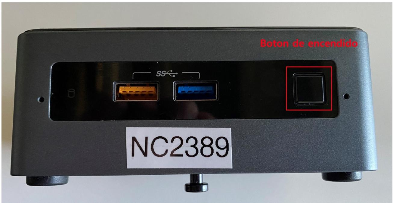
En ciertas aulas, la nuc está dentro de una caja estanca donde el encendido se hace tocando el botón señalado (un led en verde indicará que el equipo se prendió correctamente):
